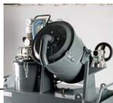
Spänebehälter einfache Entleerung durch Kurbel- Kippsystem
