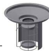
Schwimmereinrichtung mechanische Stoppeinrichtung
