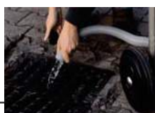
Entleerungsschlauch für Flüssigkeiten
